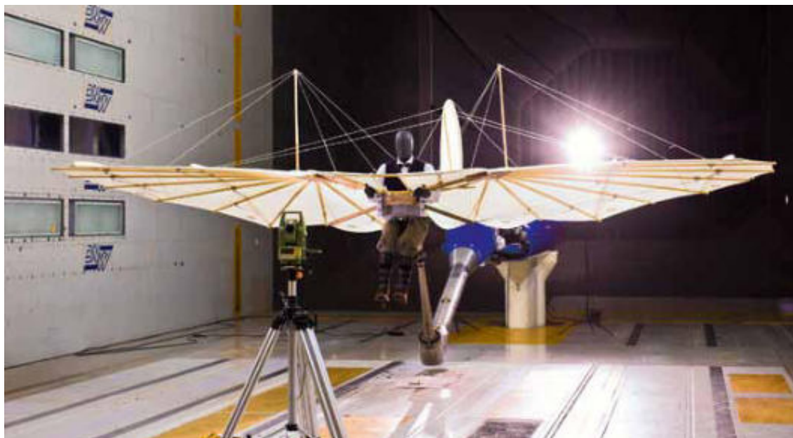
Der Lilienthal-Gleiter im größten europäischen Windkanal in der Nähe von Amsterdam. Foto: DLR
