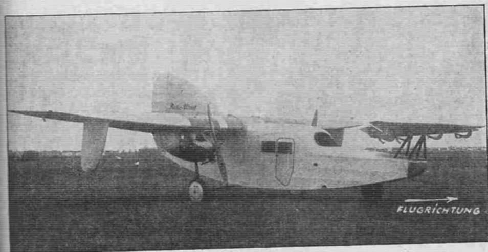
Abb. 2. Ein neuer interessanter Flugzeugtyp: Die „Ente“ von Focke-Wulf mit zwei Siemens-Sternmotoren von je 100 PS. Das Höhenleitwerk ist vorne angeordnet und tragend ausgebildet. (Archiv: v. Römer.)
