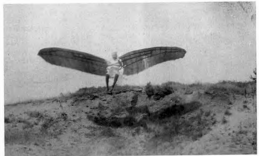
Ansicht des Piloten Otto Lilienthal direkt von vorn. Am Schatten wird deutlich, dass der Gleiter Höhen- und Seitenflosse hat. [10] [OLM F0070LF]
