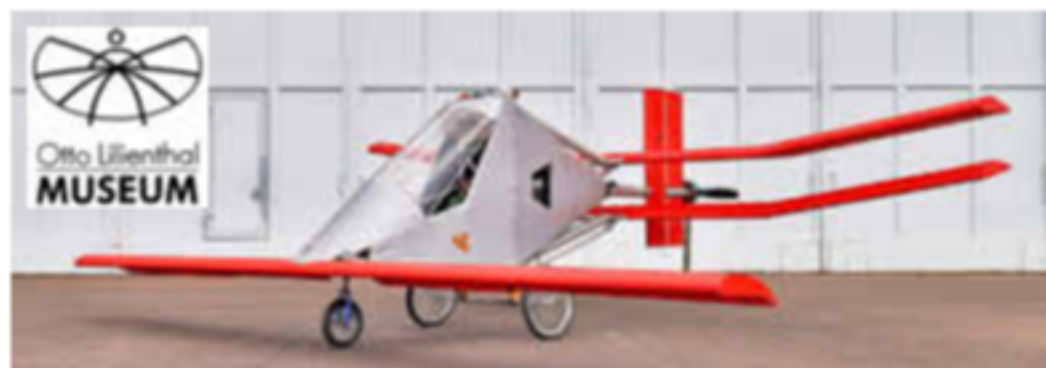
Das Hubflügelflugzeug HE210 auf dem Anklamer Flugplatz (mit eingefahrenen Hubflügeln) Foto: Otto Lilienthal-Museum
