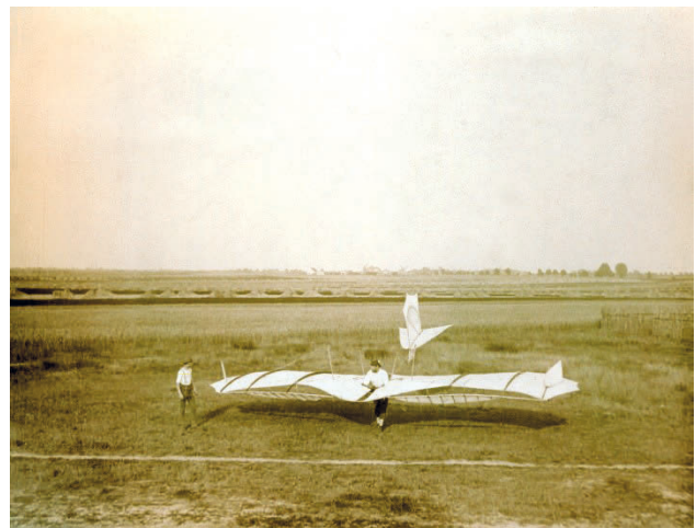
Nur aus Fotografien genau bekannt: Der von P. W. Preobrashenski fotografierte „Versuchsapparat von 1895“ verfügte über verschiedene Steuerorgane: bewegliche Widerstandsflächen, Vorflügelklappen und eine Verwindungssteuerung.
